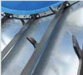
3 & 4 tooth slats grip tough uneven bales
